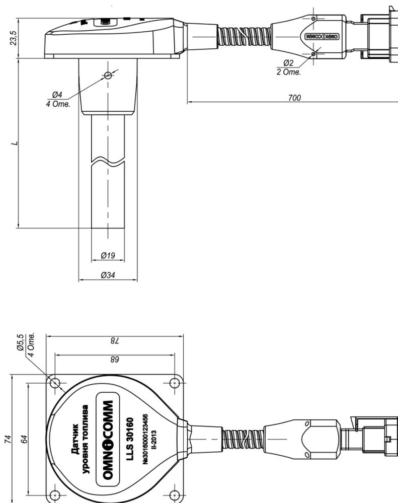
Рисунок 3,  $L$  – длина измерительной части датчика уровня топлива LLS
