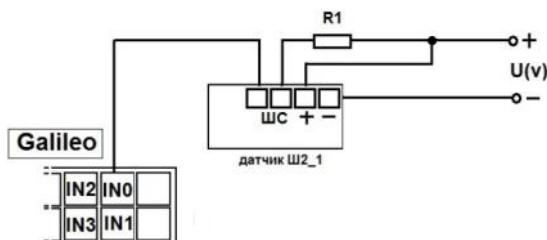
Для подключения 2x датчиков Ш2 к одному из ДАВ используем делитель на двух резисторах. Принцип подсчета реализован на изменении уровня напряжения при срабатывании датчиков.
