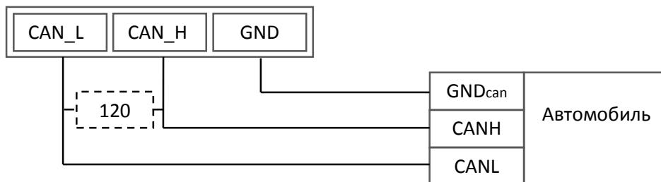
Внимание! Если законцовочный резистор (на чертеже пунктиром) не стоит в шине на ответной стороне, то необходимо его поставить. Его наличие можно определить с помощью мультиметра: при выключенном электронике автомобиля произвести замер сопротивления между CAN\_H и CAN\_L. Если сопротивление порядка 60 Ом, то законцовочный резистор не нужен, если же сопротивление 120 Ом, то необходимо подключить обычный резистор 120 Ом между проводами CAN\_H и CAN\_L.
