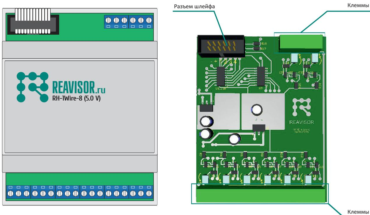
RH-1Wire-8 (5.0 V) — устройство расширения для RH-SMART-80, используемое для подключения к цифровым портам RH-SMART-80 устройств и датчиков, работающих по шине 1wire (датчики температуры DS1820, DS18B20, DS18S20, считыватели карт EM-marine, i-button, датчик температуры и влажности DTH 22 и т.д.). К каждому из 8 каналов подведён клеммник на 3 провода (+5, GND, Line). Так же в устройстве реализована защита от скачков напряжения.
