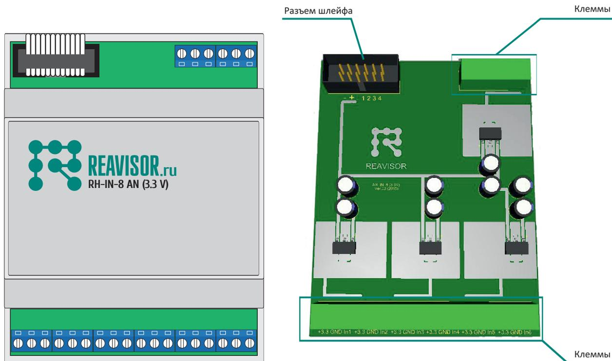
RH-IN-8 AN (3.3 V) – устройство расширения для RH-SMART-80, используемое для подключения к цифровым портам RH-SMART-80 аналоговых датчиков (датчики напряжения, температуры, влажности, освещенности и т.д.). К каждому каналу подведён клеммник на 3 провода (+3.3, GND, IN).
